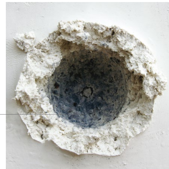
Ensaio balístico realizado em plastilina.
